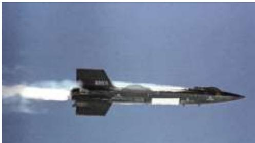
Ilustración 15: El X-15 No. 2 (56-6671) despegando de la nave nodriza B-52 con su motor cohete encendido
