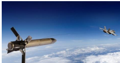
Ilustración 6: representación del AN/ALE-55, desplegado desde un Super Hornet. Foto: BAE Systems
