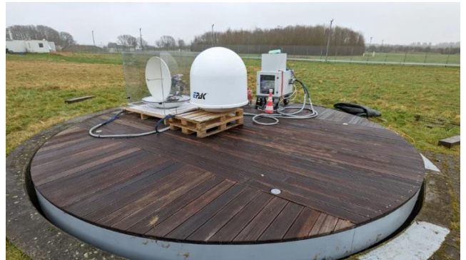
Ilustración 12: sistema de radar pasivo SABBIA 2.0 (Diego Cristallini, cortesía de Fraunhofer FHR)
